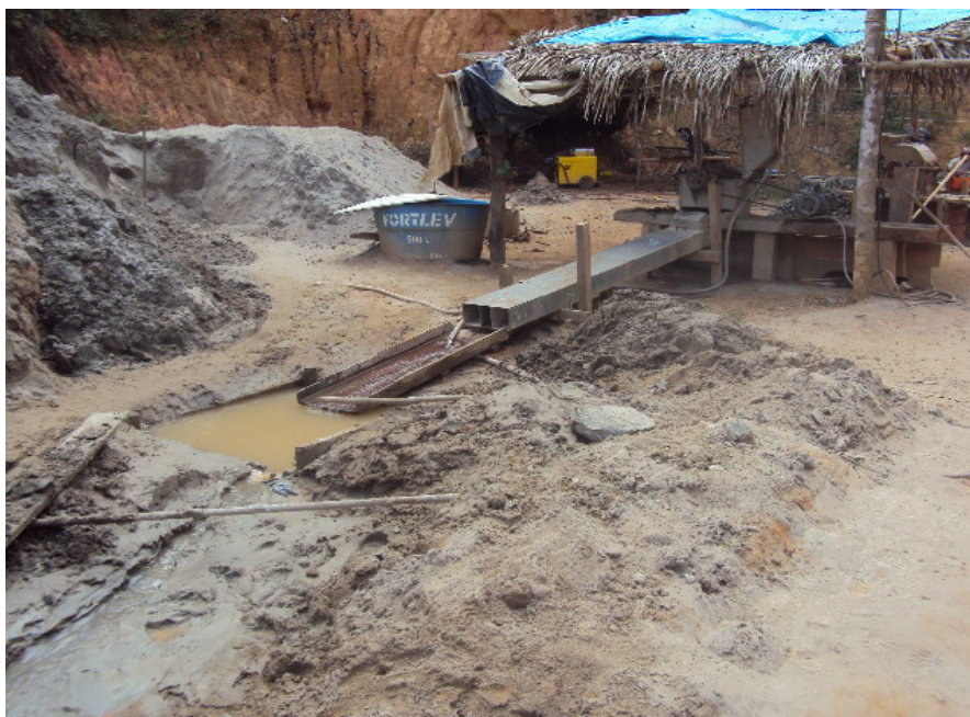
FIGURA 14.1.1-3 - Concentração do minério primário de ouro no Garimpo Ouro Verde.
